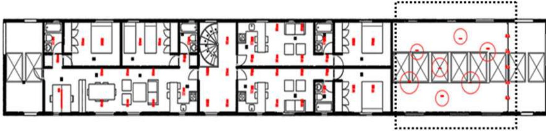
FIGURA 48 LAYOUT LUMINARIA DECORATIVA DOBLE ALTURA Fuente: Elaboración propia
